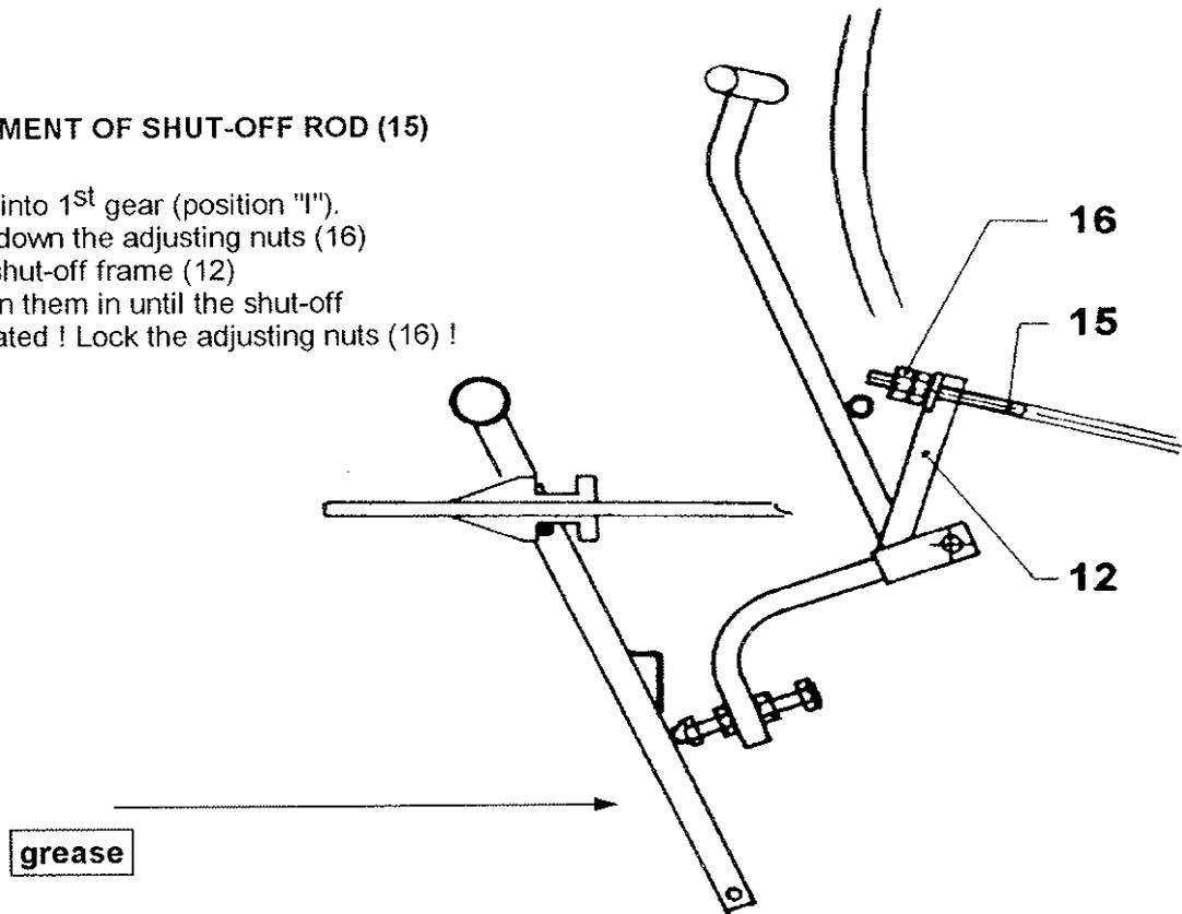
**8. TESTING 2<sup>nd</sup> GEAR SHUT-OFF**
